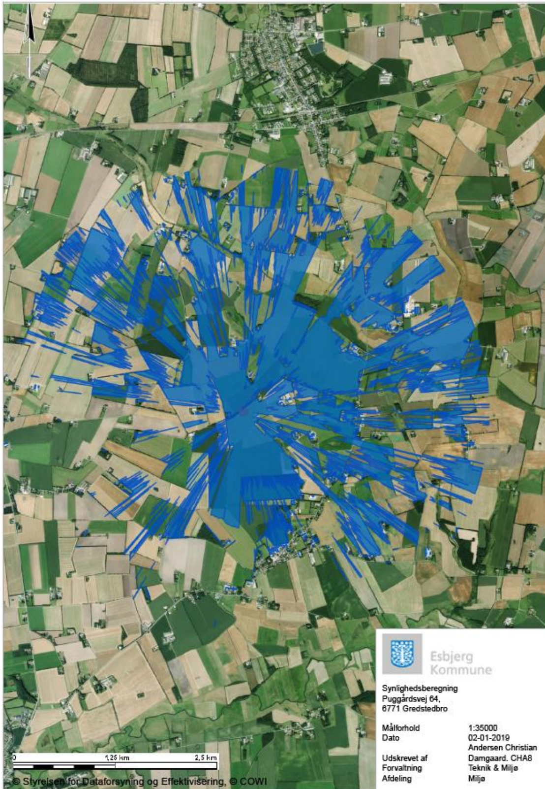
Kort 10. Synlighedsberegning – ny gyllebeholder – Puggårdsvej 64, 6771 Gredstedbro. Blå farve angiver synlighed af teltoverdækning (12,5 m høj) i det røde punkt (i 1,8 m højde).
